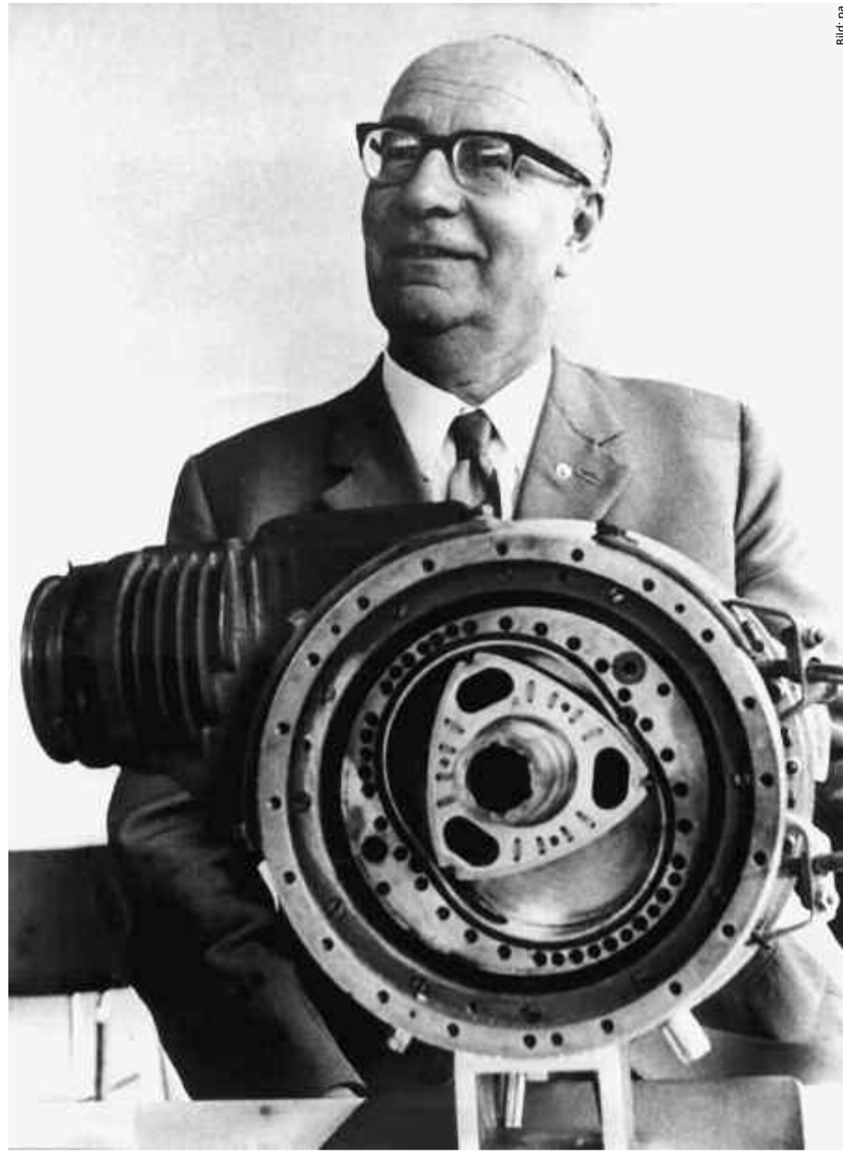
Mit einem Schnittmodell seines Drehkolbenmotors: Der Ingenieur und Erfinder Felix Wankel
