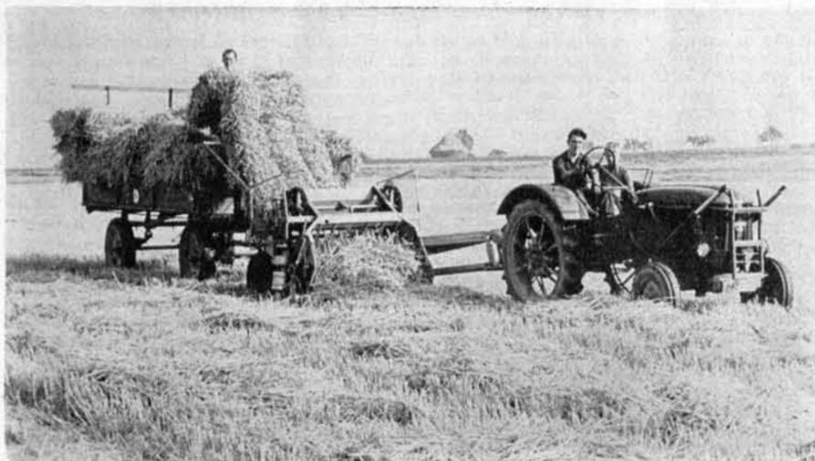
Sammel- und Ladepresse für Heu und Stroh. Ein Nachhaken ist nicht erforderlich. Eine fließende Aufnahme von Heu und Stroh ohne Stauungen durch Zusammenwirken von Aufgreifer, Zubringer und Kolben verlangen nur den Einsatz von zwei Mann.
