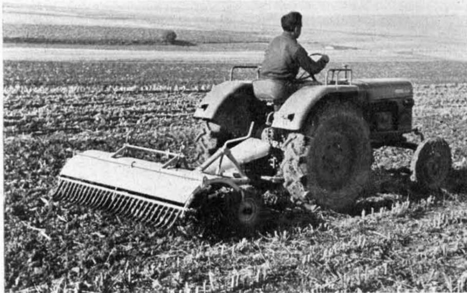
Ein Rotor-Krümler bei der Arbeit. Bei aller Technisierung bleibt nach wie vor der Grundsatz bestehen, daß „schlechtes Pflügen niemals durch Eggen, Grubbern, Fräsen und Walzen verbessert werden kann“.
