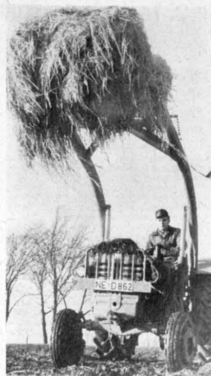
Mit jeder gefüllten Frontladergabel gelangen 2, 3, ja bis zu 5 Zentner Stallmist auf den Wagen. Die Leistung des Menschen wird dadurch um ein Vielfaches erhöht.
