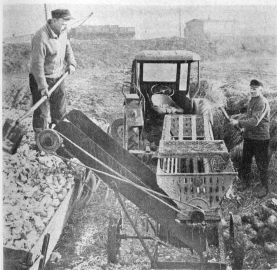
Rübenschneider mit Förderband oder Wurtschaukel an der Futterrüben-Feldmiete für das Zerschneiden der Rüben beim Verladen sowie anschließend im Stall das Abladen vom Wagen in den Futtertrogt spart Zeit und Arbeit. Siehe auch den Beitrag „Verkürzte Arbeitshilfe beim Rübenschneiden“.
