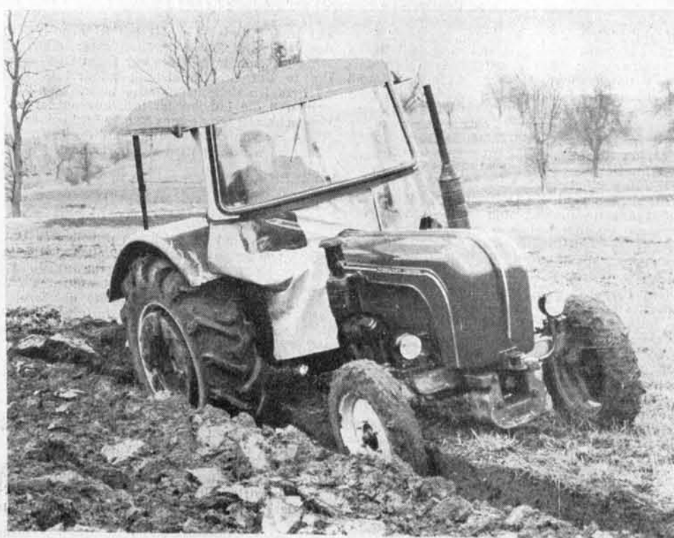
Der Porsche-Diesel-Master-Trecker, 50 PS, mit Bereifung 13—20, bei schweren Rigol-Pflügen. Landtechnischer Bilderdienst Porsche-Diesel
