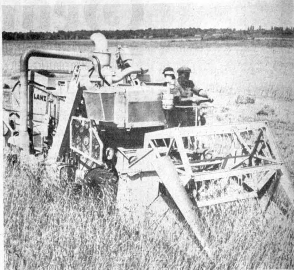
Der Mähdrescher „MD 18 S“ von John Deere-Lanz bei der Arbeit. Haspel- und Schneidwerkverstellung hydraulisch. Länge einschließlich Presse 6900 mm, Höhe 3030 mm, Breite 2500 mm, Gewicht 3090 kg.
