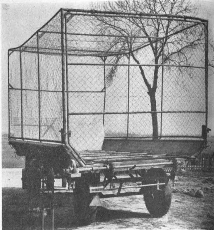
Zweiachswagen mit großräumigem Aufbau für den Einsatz hinter dem Feldhäckler, wobei das Entladen mittels des „Kurbelmax“ durch Antrieb der hinteren Welle, die den Kratzboden zurückzieht, erfolgt.
