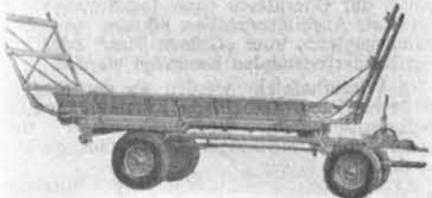
Ein Einachs-Stallmiststreuer wurde durch Einbau eines Vorderwagens und Vergrößerung des Laderaums durch Schrägstellung der Bordwände zu einem Erntewagen hergerichtet.
