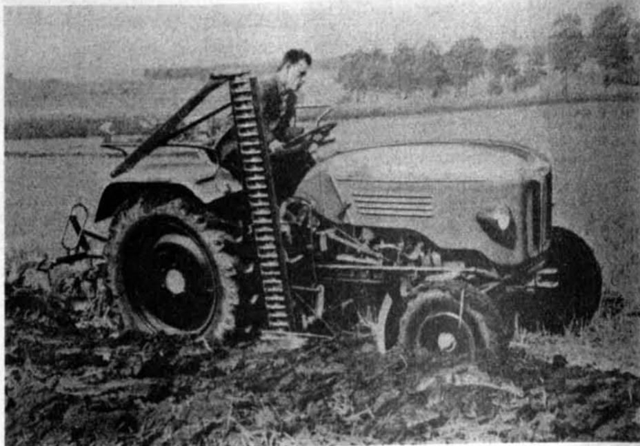
Der neue Kramer-Schlepper mit Kunststoffhaube, Zehnganggetriebe und verstellbarem Schwingsitz. Die Einzelraddrive ist mit dem Lenkrad gekuppelt und wirkt automatisch. Die Hydraulikwerkblöcke Kramer
