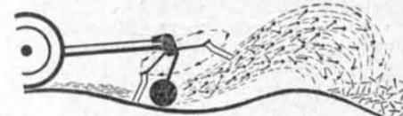
Die Arbeitsweise des neuen Fahr-Kreiselheuers. Bei der breiten Maschine werden drei Schwaden gleichzeitig gestreut. Je zwei Kreisel laufen gegenläufig.
