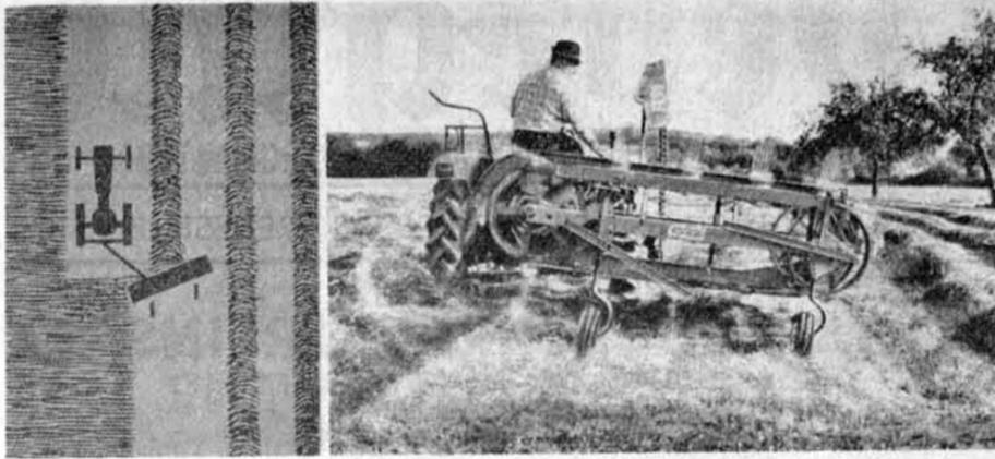
Der neue Fahr-Schnellheuer „SH 4“, hier beim Streuen von Schwaden. Da die Zinken der einzelnen Gruppen verschieden lang sind, wird der Schwad schichtweise abgebaut. (Werkbilder)
