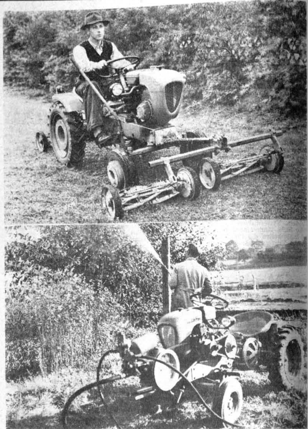
Ein 6-PS-„Hakotrac“ beim Rasenmähen mit drei Walzenrasenmähern von zusammen 1,20 Meter Schnittbreite (Bild oben). — Zur Schädlingsbekämpfung wird eine Doppelkolbenpumpe vorn aufgebaut, die bis fünfzig atü leistet. Auf dem Anhängewagen wird das Spritzmittel in einem 400-Liter-Faß mitgeführt.
