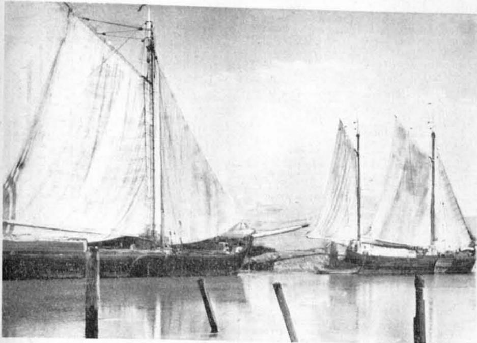
Zwei unbeladene, zweimastige Kurische Reiskähne mit Fock, Großsegel und Besan segeln den Fluß hinauf. Da der Wind fest von vorn weht, sind die Segel hart eingeholt. Die Ladefähigkeit dieser Schiffe beträgt etwa 180 Tonnen. Der Aufbau auf dem vorderen Kahn ist das sogenannte Nachthaus, in dem sich die Schiffsküche befindet. Aufnahme: Ruth Hallensleben
