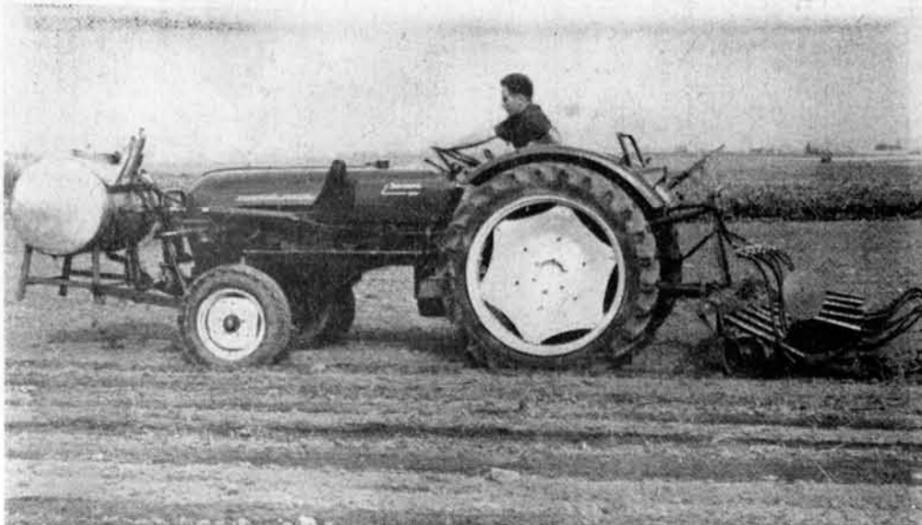
Interessante Geräte-kombination: Vorn das Faß mit der Spritzbrühe, hinter die Einzelkorn-Säugergeräte mit der Bandspritzeinrichtung. Werk-Foto
