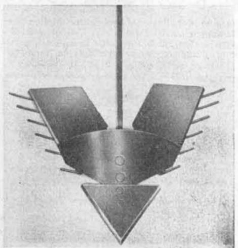
Abbildung 4: Hier sind die Häufelkörper kombiniert mit den Striegelrechen zum Hochhäufeln.
