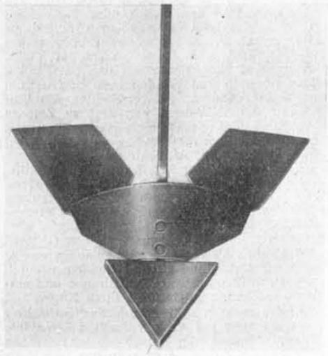
Abbildung 2: Der gleiche Häufelkörper, breit gestellt, zur ganzflächigen Blindbearbeitung.
