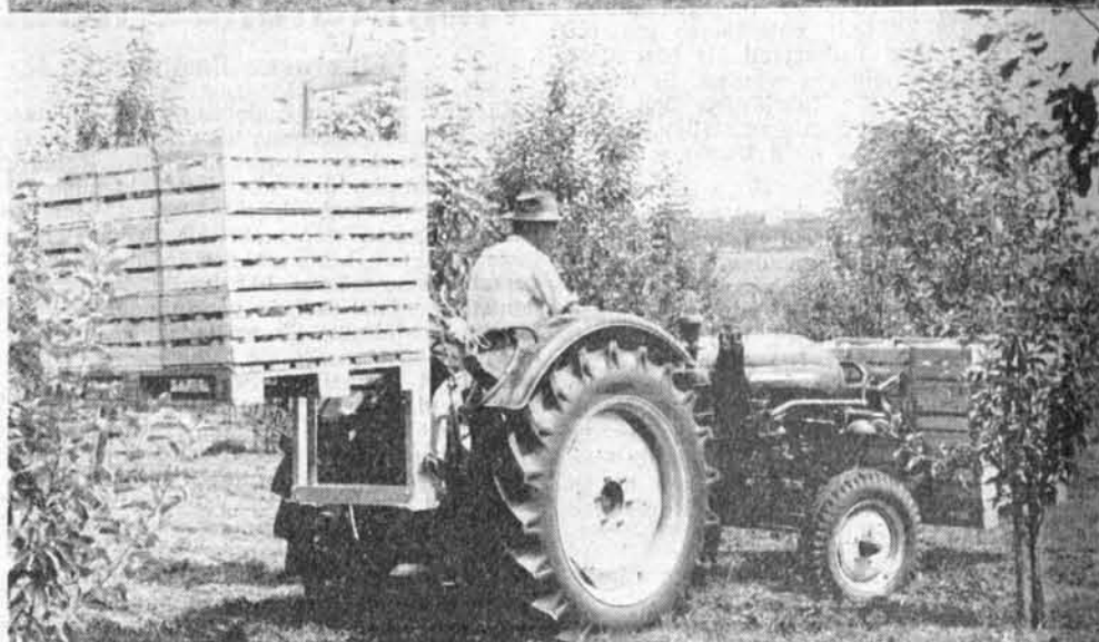
Die Technik im Obstbau. Bild oben: Das Frontmulchgerät an einem Schlepper, wobei der Anbau am Dreipunkt des Frontkrafthebers und der Antrieb durch die Frontmotorzapfwelle erfolgt. Bild Mitte: Ein Schlepper mit Frontkraftheber, ausgerüstet mit einer Einrichtung für Paletten-Transport und im Heckkraftheber den neuen Hubstapler. Bild unten: Der Heckhubstapler im Dreipunktgestänge des Krafthebers an einem Trecker.
