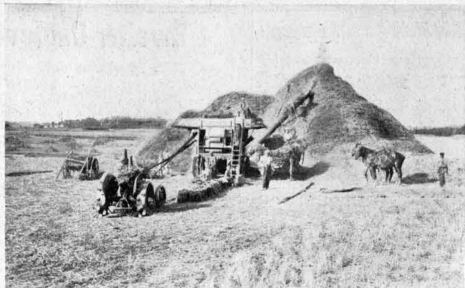
Ein Erntebild aus Ostpreußen vor dem Zweiten Weltkrieg: Der Trecker treibt den Dreschsatz, an dem ein Gebläse hängt. Dieses bringt das Stroh auf den Haufen.
