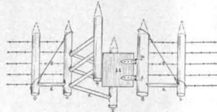
Fußgänger-Pforte für Weide-, Obst- und Gemüsegärten. Zeichenerklärung: 1-6 eingerammte Eichenpfähle, 7 etwa 80 cm lange Pfahlverstrebe besonders haltbar, 8 Drahtverstrebe für Pfahlbungen, durch Einkerbung und Festnagelung 1 und 6, 9 und 10 Stützhaken bzw. Halter für die Tür, 11 Türe, die gegen die Pfähle 3 und 4 von innen anschlägt.
