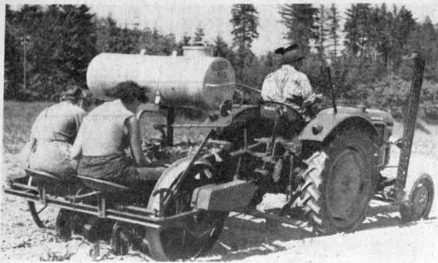
Zweireihige Pflanzmaschine mit aufgebautem Wasserbehälter. Die hohen Spurkränze der Laufräder ermöglichen auch den Einsatz am Hang. Aufn.: Werkbild
