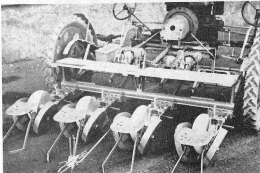
Vierreihige Gemüsepflanzmaschine mit dem Taktgeber, der den Abstand in den Reihen festlegt. Die Pflanzapparate sind an die motorisierte Schrotzer-Hackmaschine angebaut. Aufn.: Werkbild
