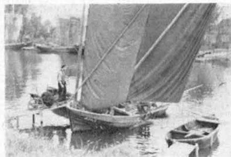
Zum Fischfang führen die Neu-Passarger mit Sicken aufs Haff hinaus. Diese tragen zwei Masten mit je einem trapezförmigen Sprietsegel, das von einer diagonal angebrachten Stange, dem Spriet, gehalten wurde. — Das Dorf Neu-Passarge wird in einem späteren Beitrag behandelt werden.
