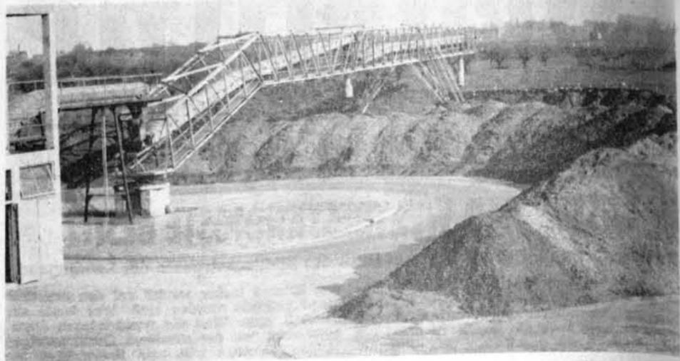
Das Müllraspelwerk in Arnhem/Niederlande mit dem Förderband, das den zerkleinerten Müll ringförmig um das Werk verteilt.
