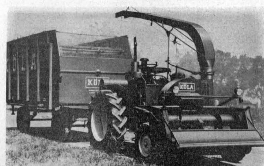
Der selbstfahrende Feldhäckslers mit 1,70 m Arbeitsbreite und 84-PS-Dieselmotor
