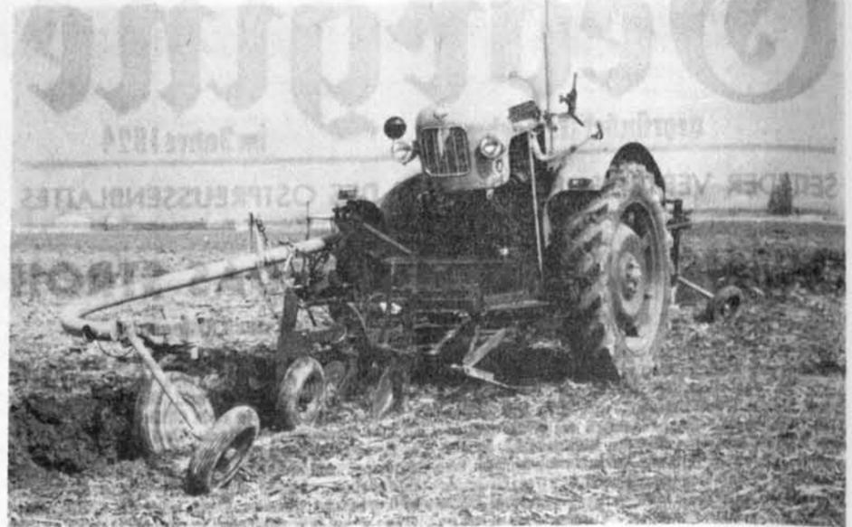
Die neue, vollautomatisch arbeitende Pflugmaschine „Agri-Robot“ mit 40-PS-Dieselmotor. Das kleine Tastrad, das am Ende der Furche in die vorher gezogene Querrfurche fällt, löst den Schalter aus, so daß sich die Maschine in die Gegenrichtung bewegt und den anderen Pflugkörper zum Einsatz bringt.
