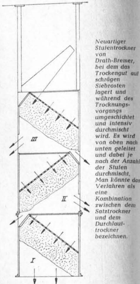
Neuartiger Stufentrockner von Dralh-Bremer, bei dem das Trockengut auf schrägen Siebrossten lagert und während des Trocknungsvorgangs umgeschichtet und intensiv durchmischt wird. Es wird von oben nach unten geleitet und dabei je nach der Anzahl der Stufen durchmischt. Man könnte das Verfahren als eine Kombination zwischen dem Satzrockner und dem Durchlaufrockner bezeichnen.
