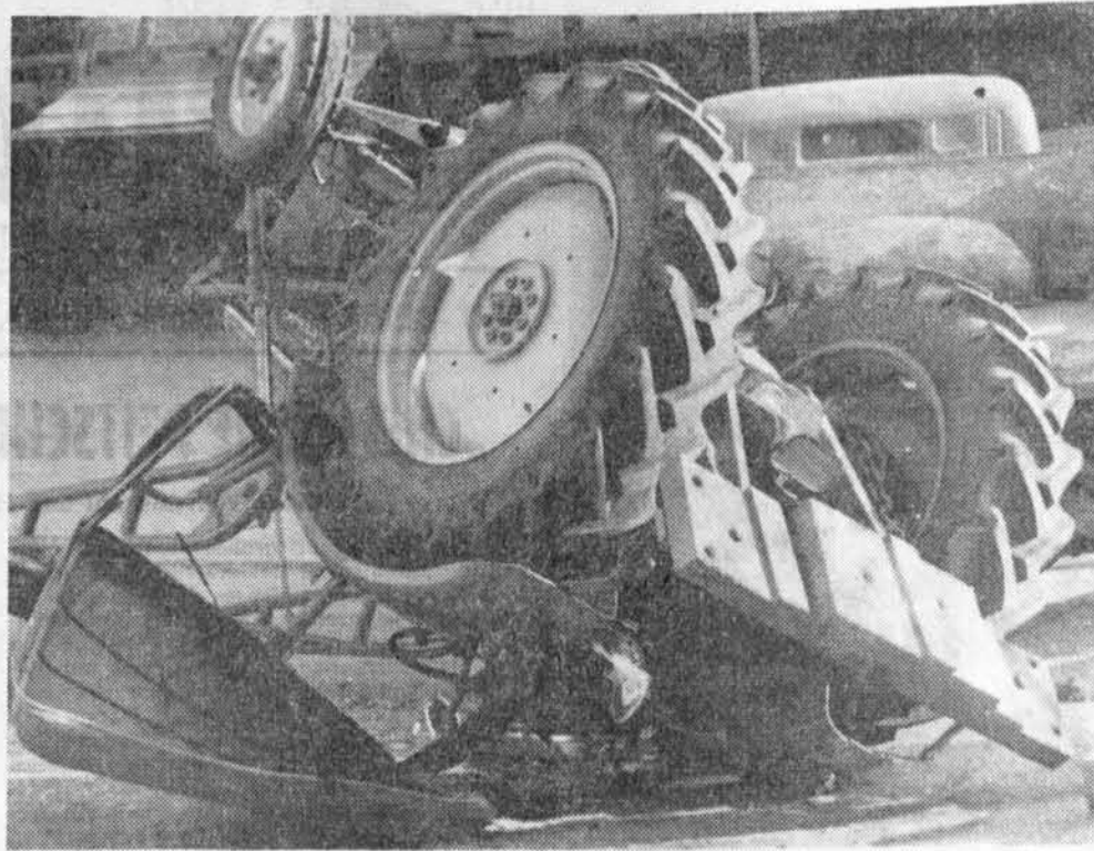
Dieser Schlepper sollte auf zwei Bohlen auf einen Lkw verladen werden. Beim Hinanfahren rutschte die eine Bohle weg, und der Schlepper stürzte so unglücklich um, daß die Räder nach oben lagen. Ohne ein umsturzsiheres Verdeck wäre hierbei der Fahrer erdrückt worden.
