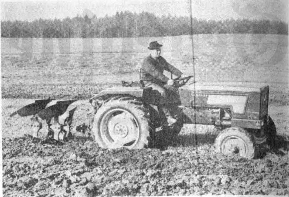
Der Hanomag-Perfekt im neuen Gewande. Der 4-Zylinder-Dieselmotor wird auch in den Lkw eingebaut und läuft im Perfekt-Schlepper gedrosselt. Der lange Radabstand erlaubt den Anbau von Zwischenachsgeräten. Die Spurweite kann zwischen 1250 und 1720 mm sechsfach verstellt werden.
