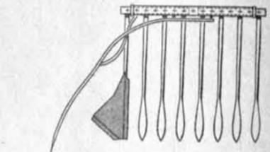
Frontladergabel zur Ernte von Silomais. Das Messer schneidet die Stengel ab, und der Drahtbügel legt sie gleichmäßig ab.
