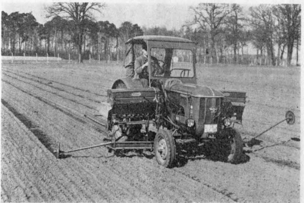
Die Drillmaschine zwischen den Achsen kann der Fahrer bequem beobachten. An einem Tage werden so mit Ein-Mann-Bedienung bis zu 40 Morgen gedriillt.
