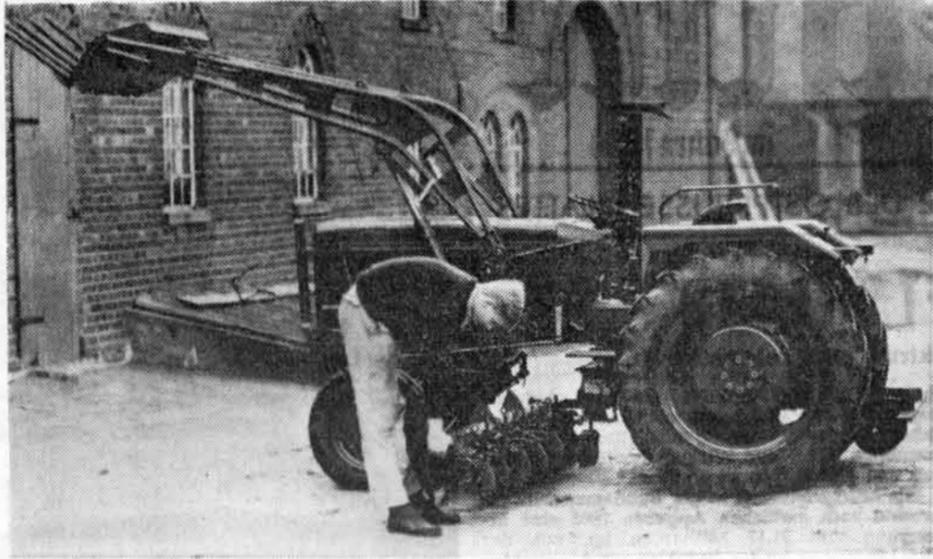
Hannomag ist der Idee des Tragschleppers treugeblieben und zeigte bei der Frankfurter DLG-Ausstellung 1966 erstmalig einen 40-PS-Schlepper, der zusätzlich die Möglichkeit der Geräteanbringung zwischen den Achsen bietet.
