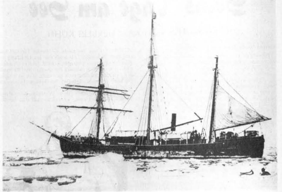
Drygalskis Forschungsschiff „Gauß“ der Deutschen Südpolexpedition 1901/03 (1442 BRT, Länge 42,7 Meter, Breite 11,27 Meter, Geschwindigkeit sieben Seemeilen)
