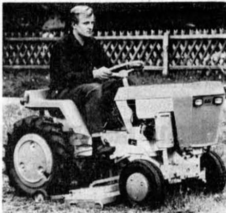
Einer der „Gartenzwerge“, die es hinsichtlich technischer „Finessen“ (hydraulischer Fahrtrieb, hydraulische Aushebung der Anbaugeräte) den „Großen“ gleich tun, hier mit einem Rotormäher. (Werkbild)
