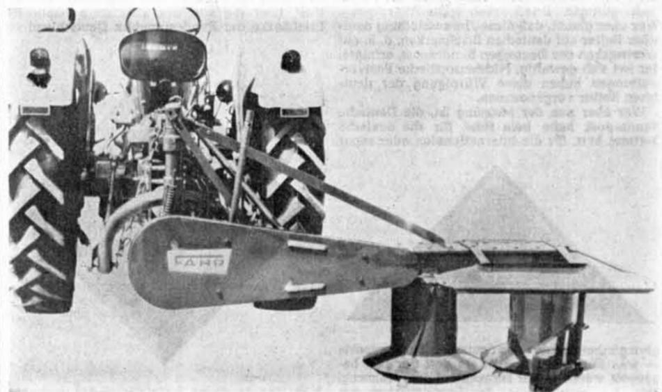
Rotor- oder Kreisel-Mäher mit Obenantrieb der Trommeln im Dreipunkt-Kraftheber. (Werkbild)
