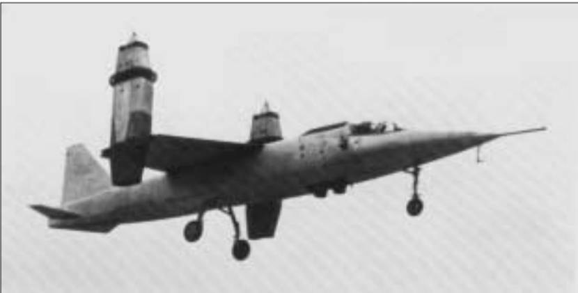
VJ 101 C X1 im Schwebeflug und im konventionell-aerodynamischen Flug: Die Gegenüberstellung der linken Aufnahme vom ersten Schwebeflug am 10. April 1963 mit dem später aufgenommenen rechten Foto zeigt deutlich die variablen Einsatzmöglichkeiten der schwenkbaren Triebwerke des Senkrechtstarters
