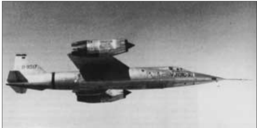
VJ 101 C X1 im Schwebeflug und im konventionell-aerodynamischen Flug: Die Gegenüberstellung der linken Aufnahme vom ersten Schwebeflug am 10. April 1963 mit dem später aufgenommenen rechten Foto zeigt deutlich die variablen Einsatzmöglichkeiten der schwenkbaren Triebwerke des Senkrechtstarters
