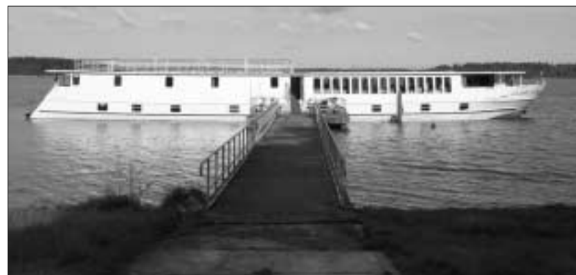
„Classic Lady“: Das unter polnischer Flagge fahrende Motorschiff wurde 2003 in Nikolaiken gebaut und in Dienst gestellt. Es hat eine Länge von 44 Metern, eine Breite von 7 Metern und einen Tiefgang von einem Meter. Fünf oder sechs Crewmitglieder betreuen bis zu 40 Passagiere, für die neben 20 Außenkabinen a elf Quadratmetern ein Panorama-Restaurant, eine Bar und ein Sonnendeck zur Verfügung stehen.
