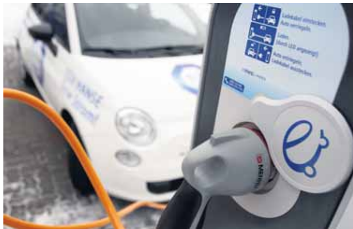
Ab an die Steckdose: Die 15 bis 20 Kilowattstunden nachzuladen, die ein Kleinwagen auf 100 Kilometer benötigt, dauert über eine normale Haushaltssteckdose etwa sechs bis acht Stunden. Wer sich einen Drehstromanschluss in die Garage legt, kann auf unter zwei Stunden kommen. Bild: ddp
