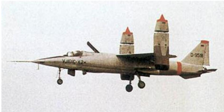
Charakteristisch sind die schwenkbaren Gondeln mit den Haupttriebwerken an den Flächenenden: Senkrechtstarter und Überschalljäger VJ 101C von EWR im Schwebeflug
