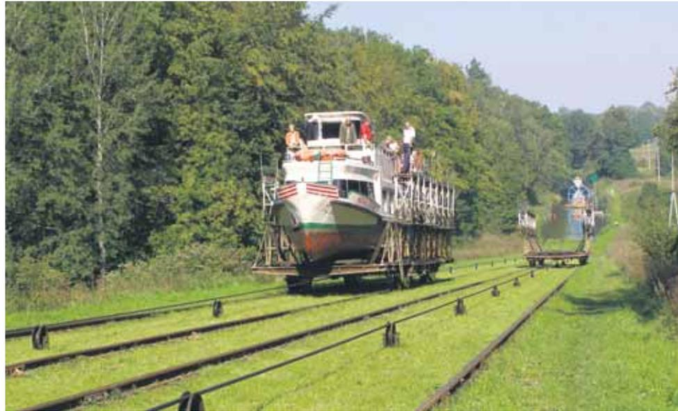
Uriges Schienenfahrzeug: Ein Schiff überwindet den Höhenunterschied bei Elbing auf dem Landweg
