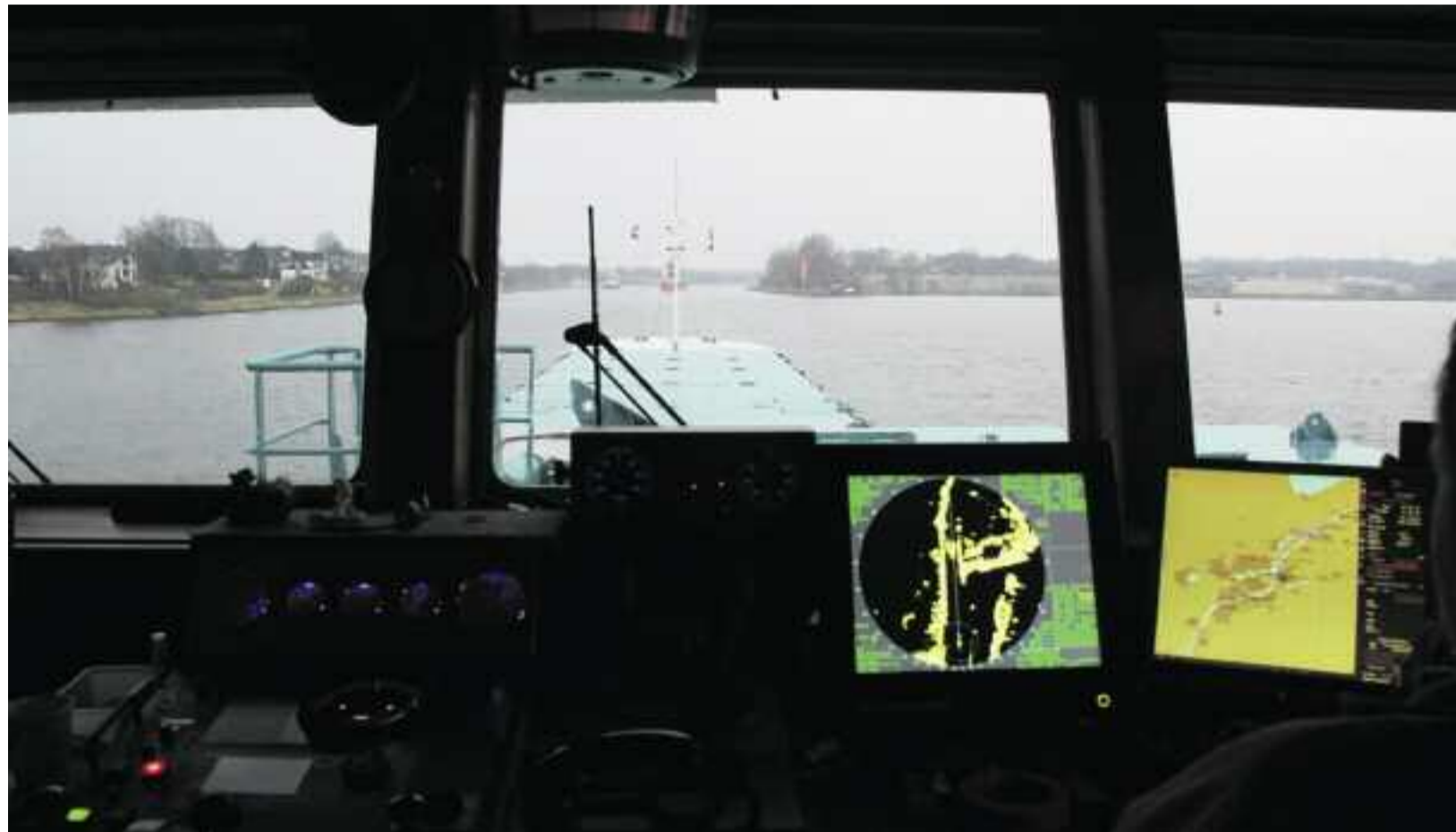
Kümonautenblick: Mit Hilfe von Radar auf der Brücke wird die „Fredo“ durch den Nord-Ostsee-Kanal navigiert
