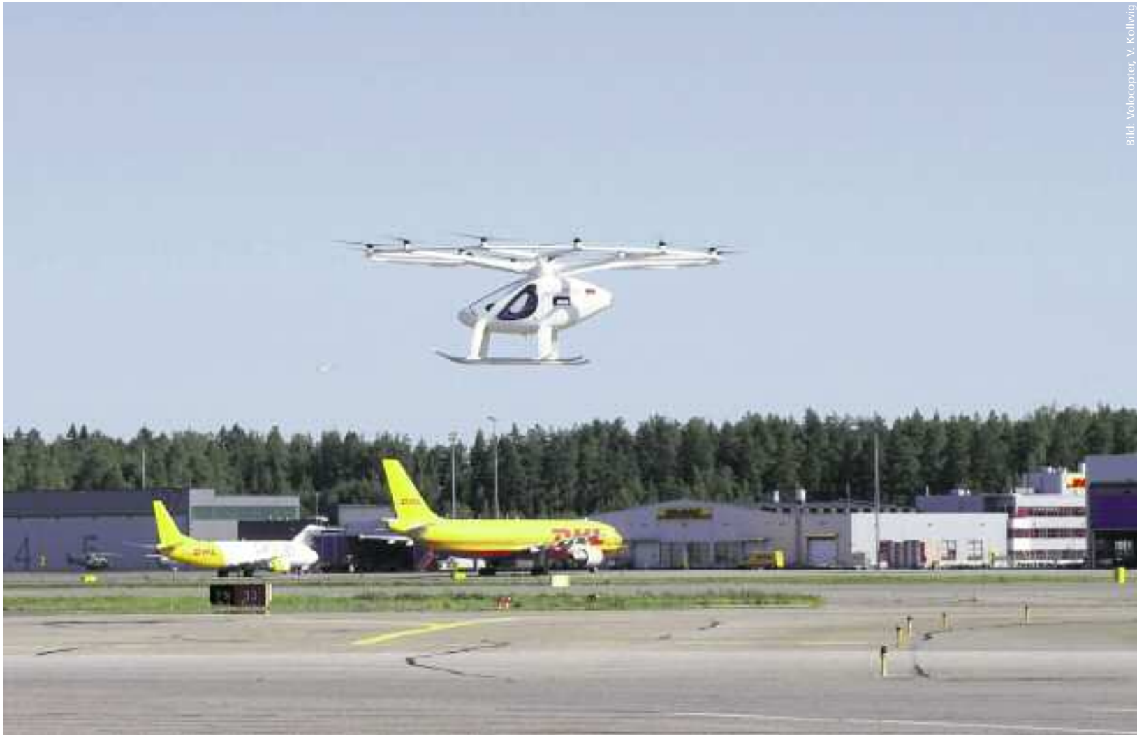
Über dem Flughafen Helsinki-Vantaa: Ein Volocopter mit zwei Sitzen sowie jeweils 18 Rotoren und Elektromotoren
