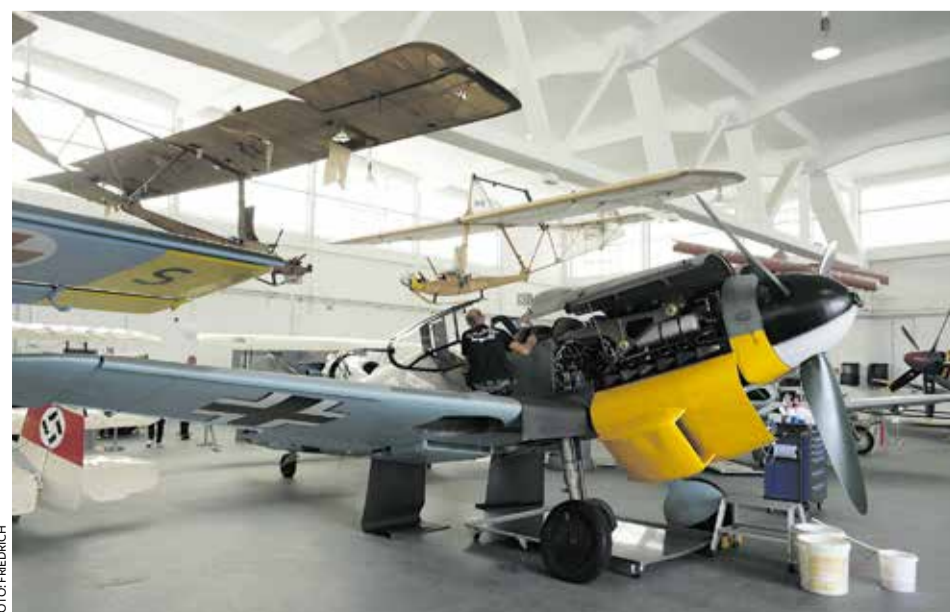
Hat den Krieg überlebt: Wartungsarbeiten an einer Messerschmitt Bf 109 G von 1944
