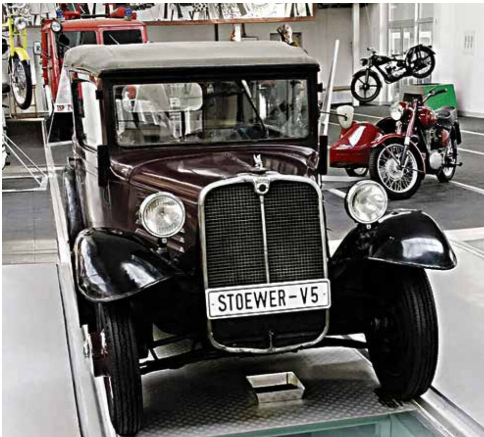
Der erste deutsche Serienwagen mit Frontantrieb und Schwingachse: Der Stoewer V 5, ein Kleinwagen von 1931
