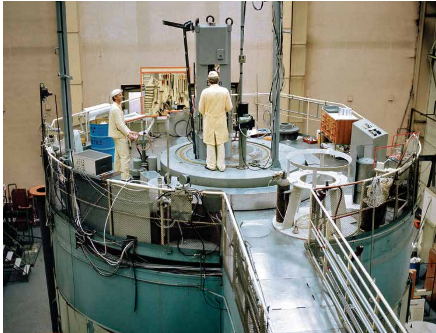
Rossendorf bei Dresden: Von 1957 bis 1991 war der sogenannte Rossendorfer Forschungsreaktor (RFR), der hauptsächlich als Neutronenquelle eingesetzt wurde, in Betrieb
