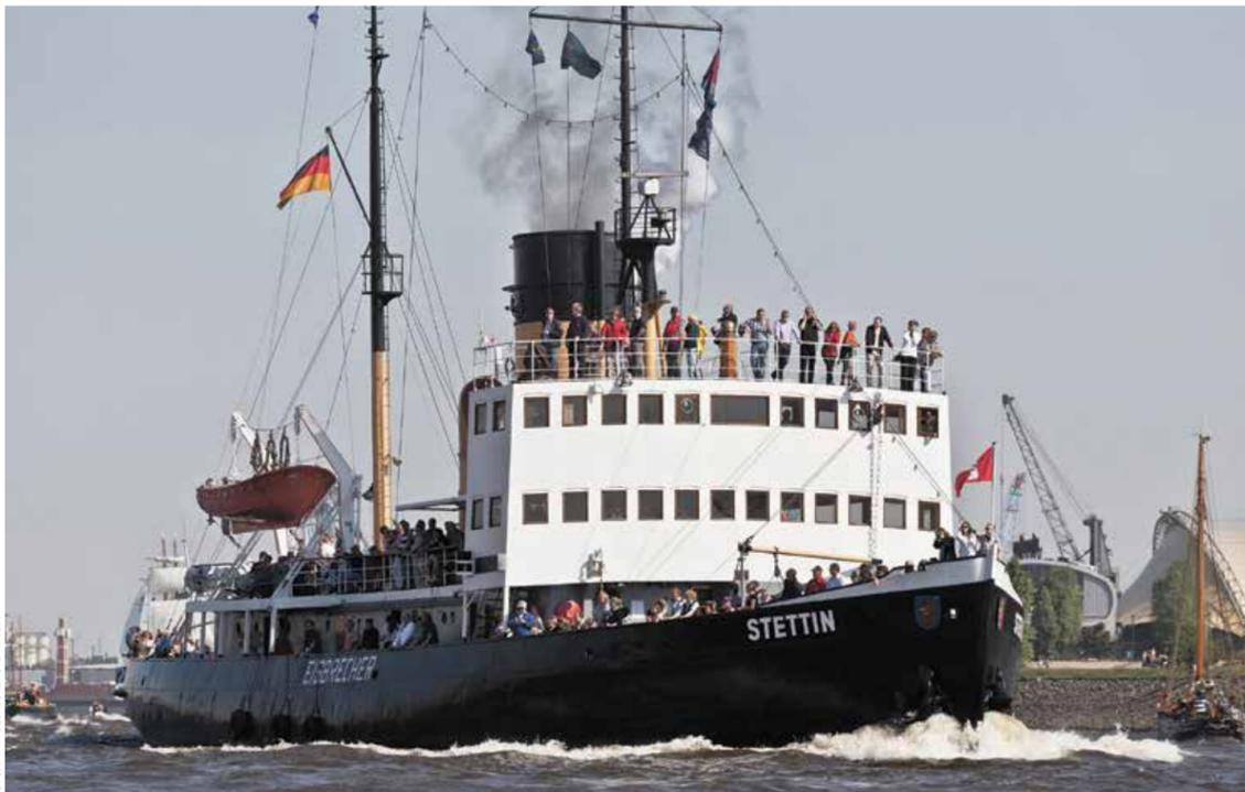
Ein Kraftpaket ist unterwegs: Angetrieben von einer Dreifach-Expansions-Kolbendampfmaschine mit 2200 PS
