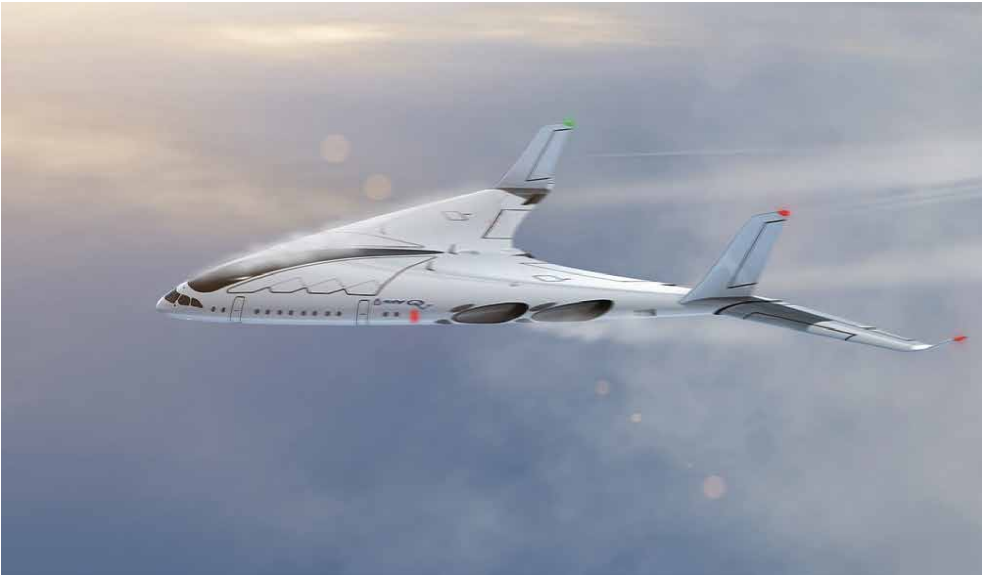
Nurflügler für 300 Passagiere: Entwurf für ein neues Überschallflugzeug
