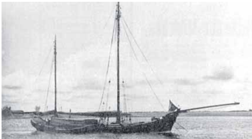
Dieser Kurische Reisekahn, ein Schoner, hat durch ein volles Jahrhundert das Bild auf den ostpreussischen Flüssen bestimmt. Solche Kähne entstanden aus der Notwendigkeit, den ständig anwachsenden Güterverkehr zwischen Kowno und Königsberg zu bewältigen. Ihr Rumpf, aus starken Eichenplanken gezimmert, hielt auch der stärksten Dünung auf dem Kurischen und dem Frischen Haff stand. Die auffallend hohen Masten entsprachen den teilweise steil ansteigenden und bewaldeten Ufern am Memelstrom, die den Segeln den Wind abfingen. Die Tragfähigkeit der Kurischen Reisekähne betrug etwa zweihundert Tonnen = viertausend Zentner.
