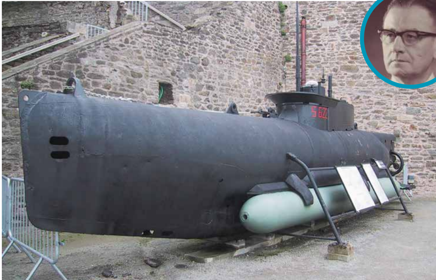
Die kleine U-Boot-Klasse vom Typ „Seehund“ von Christoph Aschmoneit (o.r.) war ein Unterwassergefährte für zwei Personen, das neue Maßstäbe setzte. Kaum ein anderes Kleinst-U-Boot konnte damals so tief tauchen Bild: Zubro/Wikimedia; vfcg.eu
